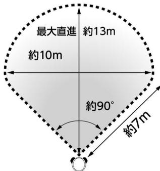
※センサー感知範囲内に障害物がある場合は、死角が発生します。死角内ではセンサーが感知できないため、ご注意ください(右図)。
