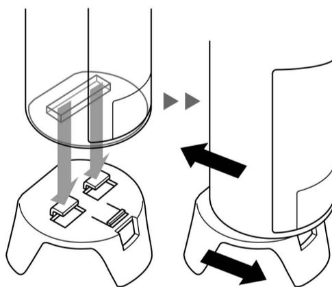
図のように本体穴に三脚凸部を合わせます。矢印方向に本体と三脚をすべらせて取り付けてください。本器の使用の際には必ず三脚のご使用をお願いいたします。
