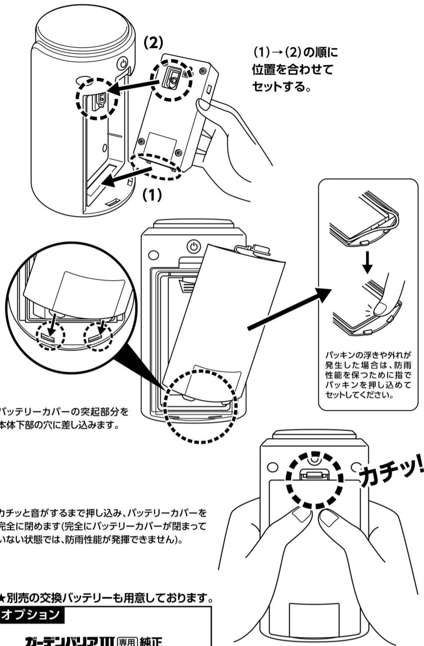
バッテリーカバーの突起部分を本体下部の穴に差し込みます。
