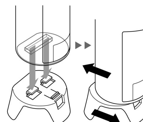
図のように本体穴に三脚凸部を合わせます。
